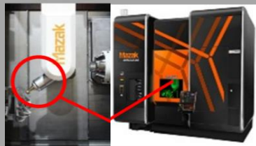
ヤマザキマザック株式会社 複合加工機 へのレーザーコーティングヘッド搭載
