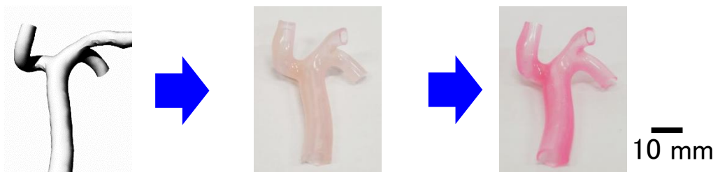
患者の腎動脈データ腎血管モデル（加熱前） 90℃加熱後
