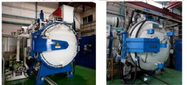
W600・H600・L900 実用真空加熱炉：不安定な窒素熱処理
