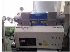
ラボ装置：再現性の良い窒素熱処理
